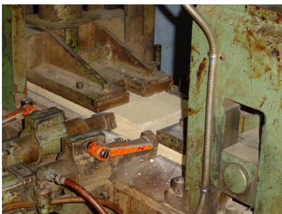
Slika 7 Stroj za nanošenje tlačne sile kod spajanja lamele
