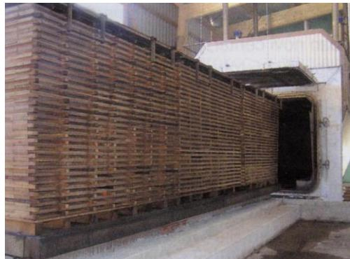
Slika 3 Tunel za sušenje
