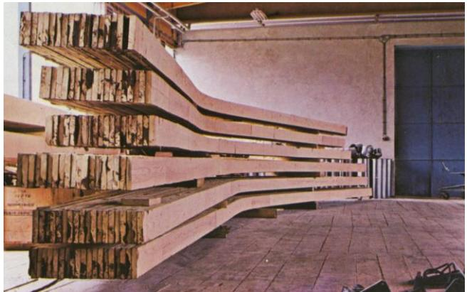
Slika 13 Zakrivljeni nosači izvađeni iz kalupa
