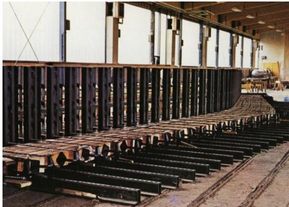
Slika 12 Kalup za lameniranje zakrivljenih nosača
