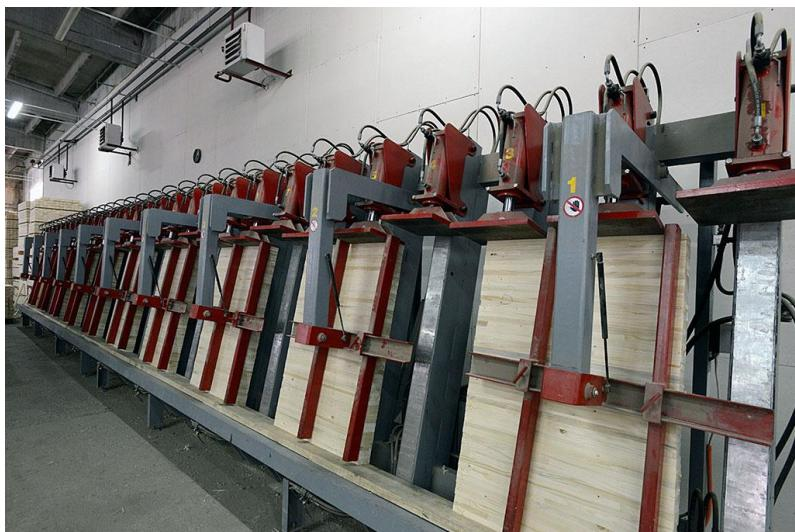
*Slika 10 Preša za proizvodnju ravnog lameliranog nosača*
