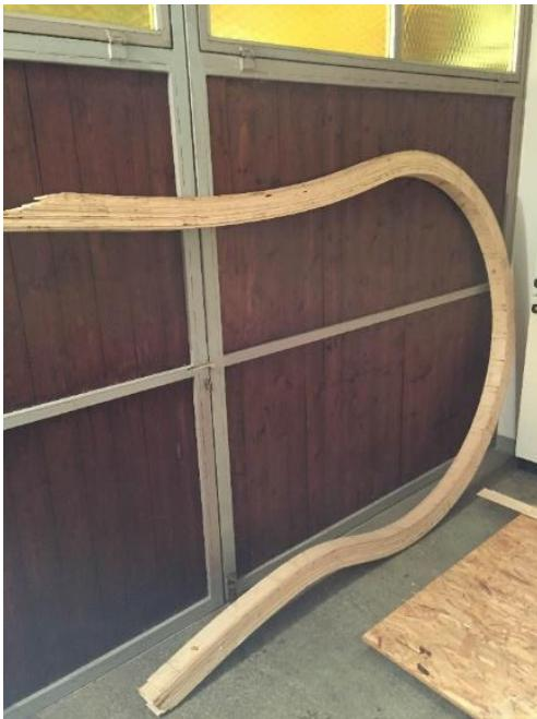
Slika 15 Lamelirani zakrivljeni nosač debeline lamele 5 mm
