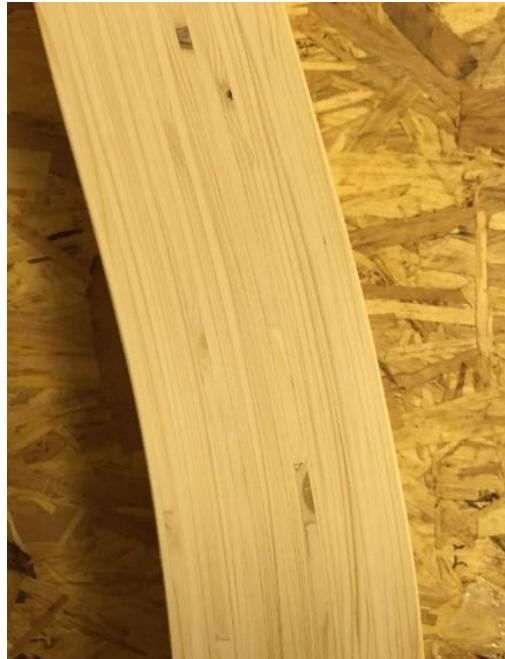
Slika 16 Struktura nosača sa lamelom debeline 5 mm nakon blanjanja
