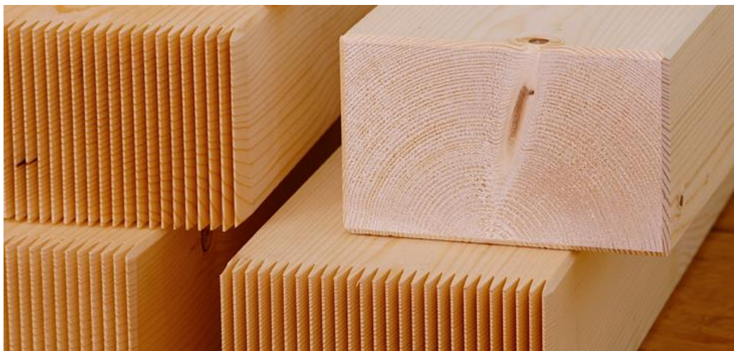
Slika 4. KVH drvo sa prikazom zupčastog spoja
