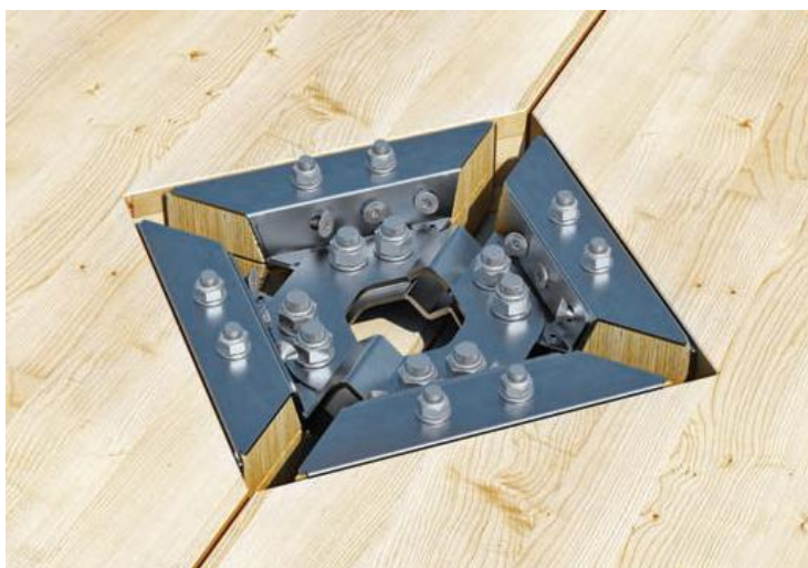
Slika 18 Spoj međukatne konstrukcije i zidovima sa X-RAD elementima
